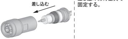
④ コネクタ本体に差し込み締付金具で固定する。
